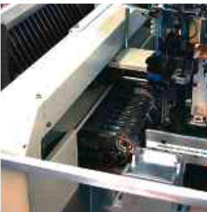
Beispiel einer maschinellen Bestückung von Leiterplatten.
